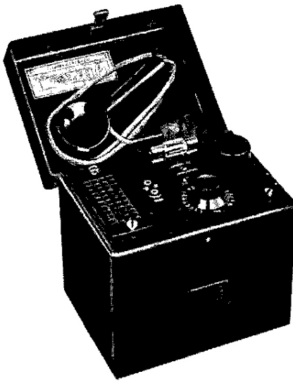
4.3. ábra Barkhausen szubjektív hangosság szintmérője, amelyből a Siemens cég csak néhány darabot gyártott
