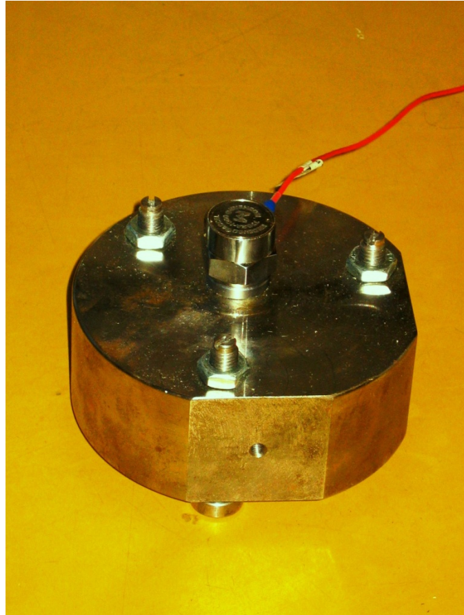
144. ábra Álló, fekvő helyzetben ható egésztest rezgés érzékelője
