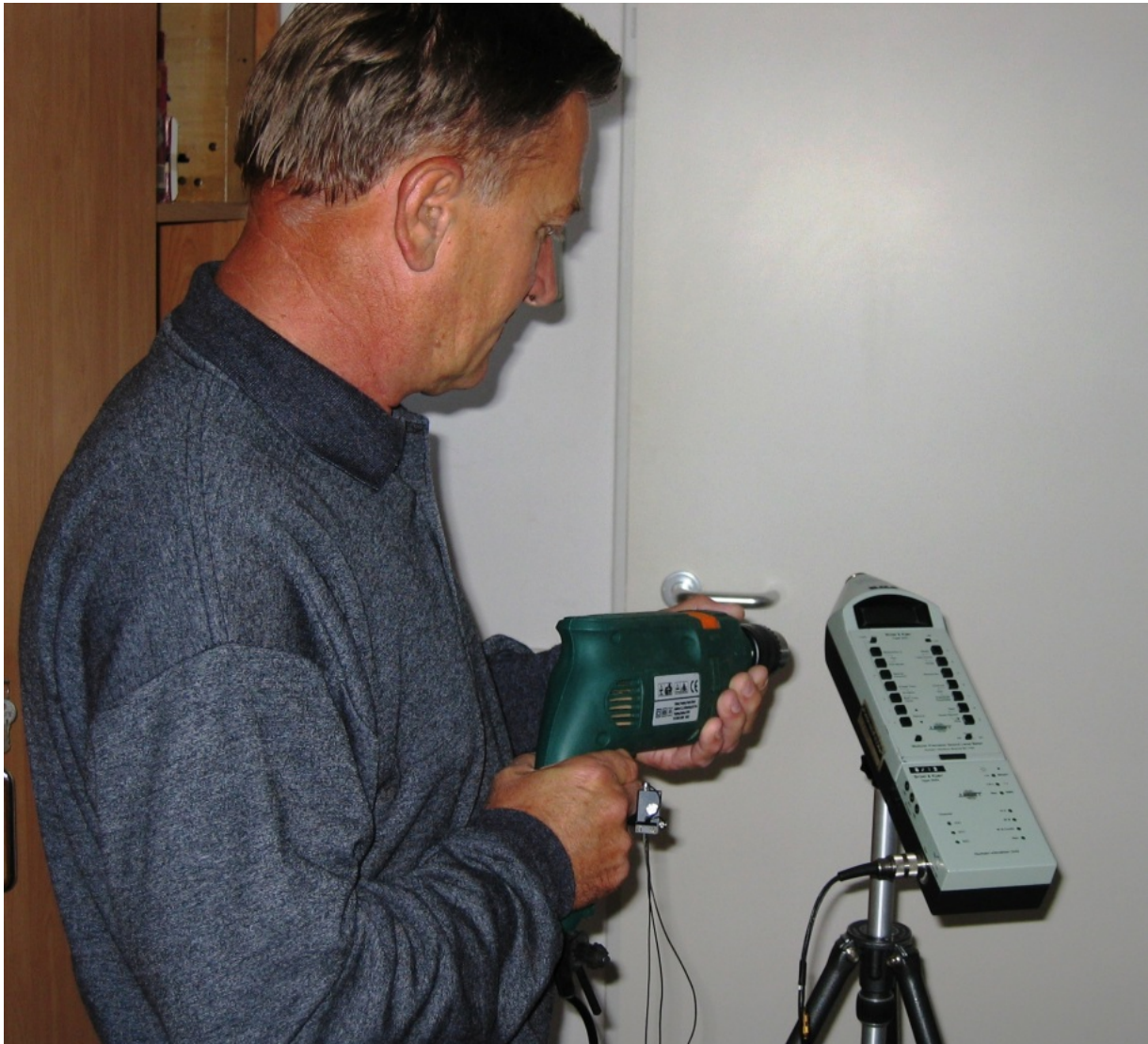
146. ábra A rezgésérzékelő elhelyezése kézi fúróval történő munkavégzés esetén
