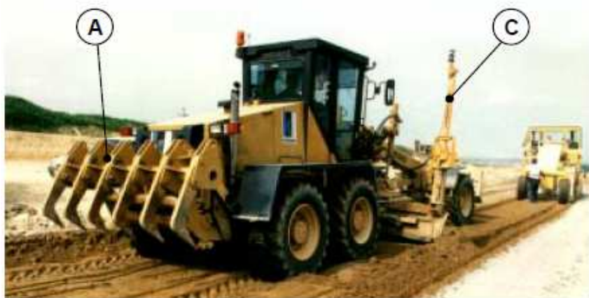
Talajlazító (A) és tolólap (B) munkaeszközökkel felszerelt, lézer-vezérlésű (C) földgyalu
