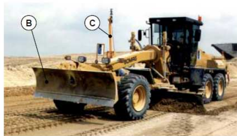
Talajlazító (A) és tolólap (B) munkaeszközökkel felszerelt, lézer-vezérlésű (C) földgyalu
