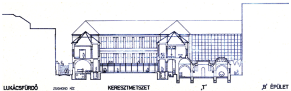
1. ábra. A Császárfürdő alaprajza és keresztmetszete, a szerelt kőlábazat volumenének, helyének ábrázolásaként [tervező: Szende Árpád (BVTV)] (folytatás a 2. ábrán)
