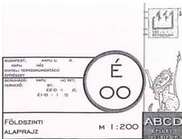
12. ábra. Nem megfelelő és megfelelő rajzpecsét és megjegyzések
