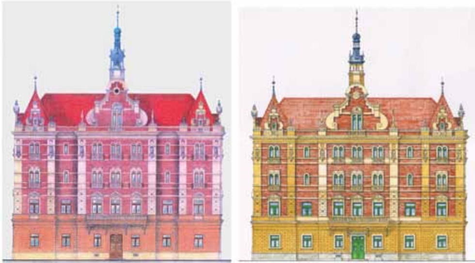
7. ábra. A helytelen, és a helyes homlokzat felújítás (Pfaff Ferenc: Szegedi MÁV Ig.) /MSZ 7300 – 2002./
