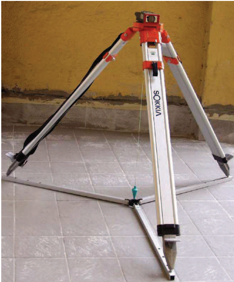
Lézerszűrő műszerállványon, állványrögítő csillaggal
