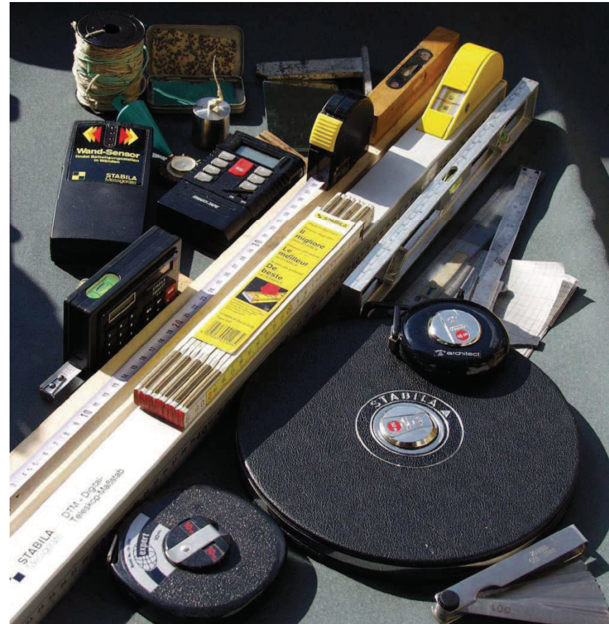
Geometriai paraméterek méréséhez szükséges vizsgáló és egyéb eszközök
