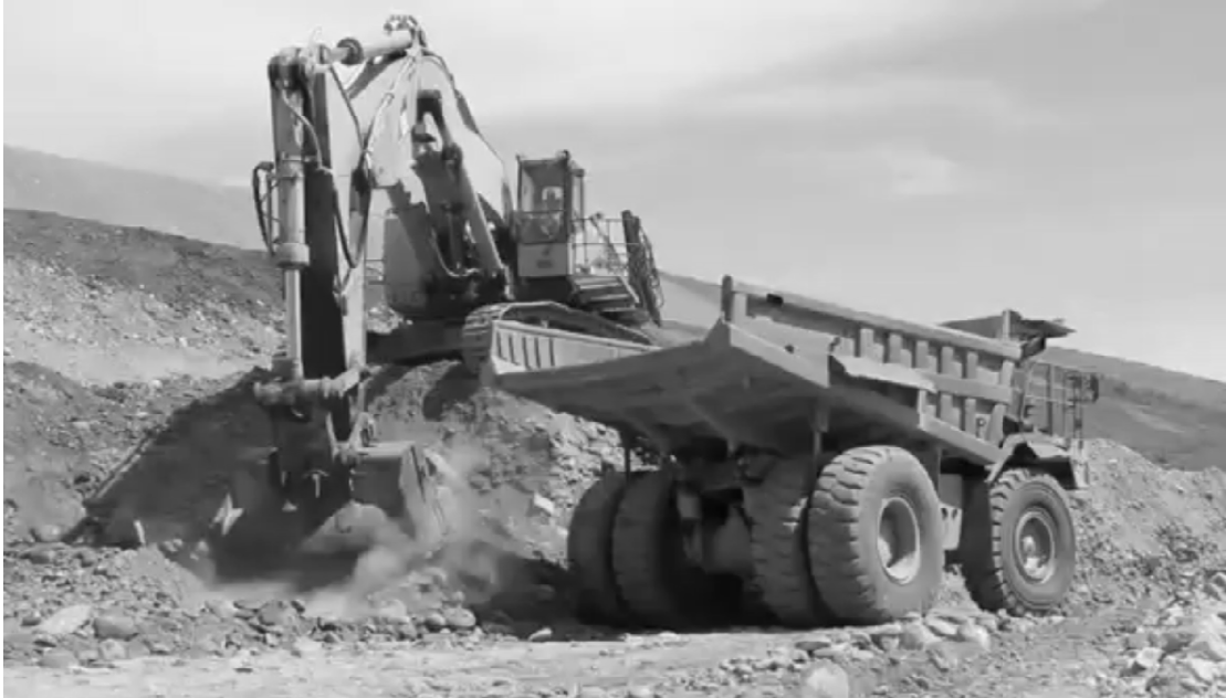
11. ábra. A kotró és a szállítóeszköz különböző terepszinten.
