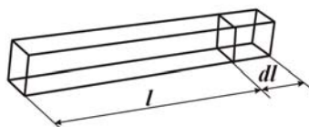
7.2. ábra. Hosszváltozás lineáris hőtágulás esetén
