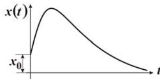
5.15. ábra. Kritikus csillapítású rendszer aperiodikus kitérése
