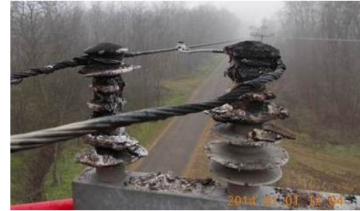
Madárvédő burkolat (szigetelőre). Összes eddig használt típus letiltásra került.
