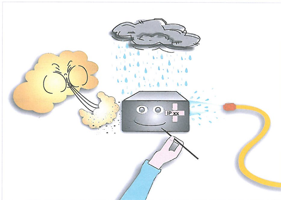
26. ábra: IP-védettség – A tokozat védelme
