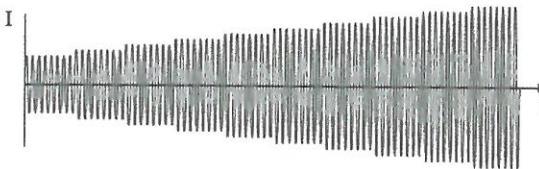
73. ábra: Áramgörbe formája a kioldási áram méréséhez
