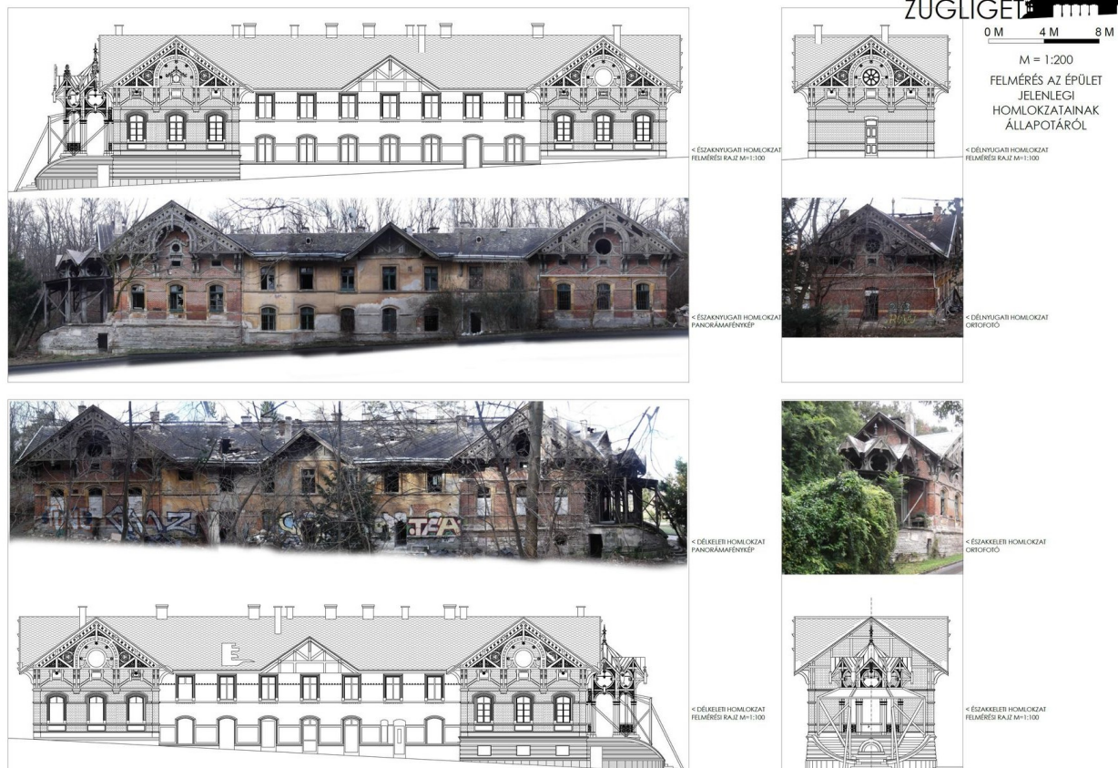
Egykori zugligeti indóház felmérése, a homlokzatrajzokon és a fotókon jól láthatók a rongálódások (Forrás: Patak Gergely)
